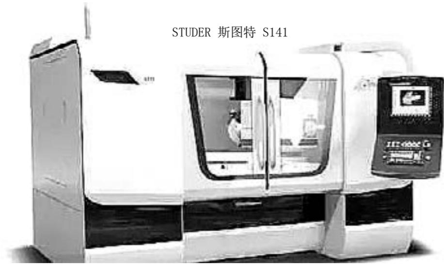
在CIMT2015第十四届中国国际机床展览会上的展品中，S141是最新一代数控万能内圆磨床，其综合了最新的技术于一身：所有轴都配备了直线驱动装置；工件台可自动回转，以采用轴向平行磨削方式磨削锥度/锥体；最多可配备两个修整工位，杰出的修整方案满足任何应用需求；
